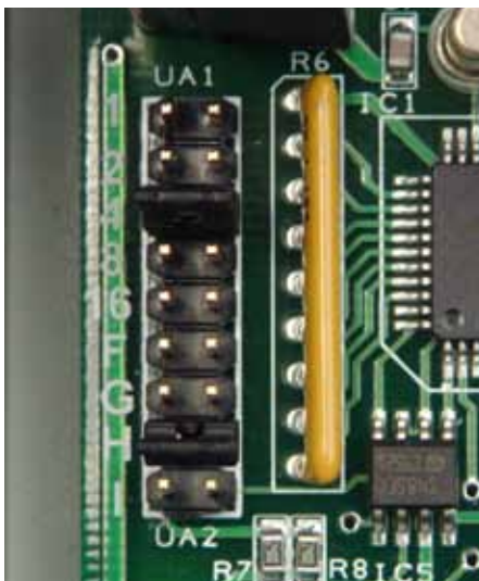
Bild utvisande bygel H och 4 är på. (Betyder fristående drift och endast spjällgrupp 1 används.)
